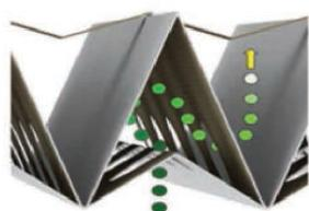
Grazie all'effetto dei **cambiamenti di direzione** che l'aria è costretta a compiere nel suo tragitto all'interno delle pieghe con il filtro inerziale Binks si ottiene la **separazione delle particelle solide** trasportate dal flusso d'aria.
